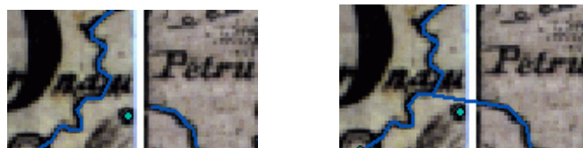
Obr. 3.17: Spojování nedotažených vodních toků - stav před a po editaci
