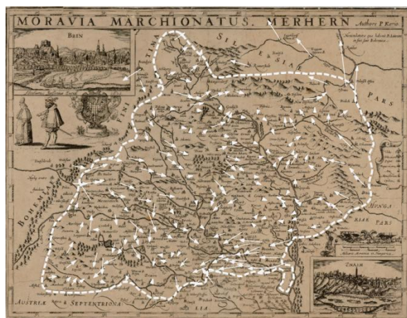
Obrázek 3: Vlevo: Vektory opravy na identických bodech v měřítku 2:1 u Kaeriovy mapy Čech. Vpravo: Vektory opravy na identických bodech v měřítku 2:1 u Kaeriovy mapy Moravy.
