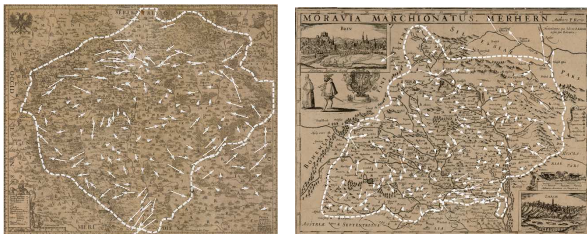
Obrázek 3: Vlevo: Vektory opravy na identických bodech v měřítku 2:1 u Kaeriové mapy Čech. Vpravo: Vektory opravy na identických bodech v měřítku 2:1 u Kaeriové mapy Moravy.
