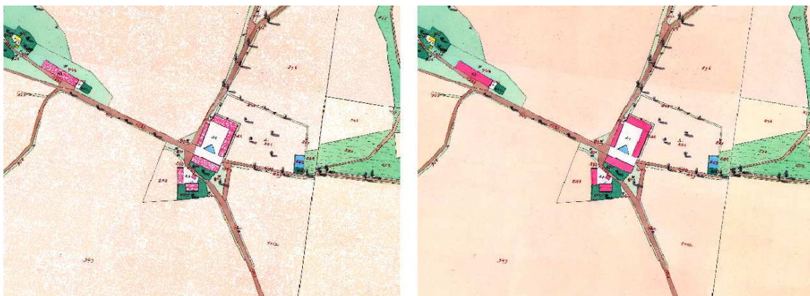
Obr. 21: Mozaika bez úpravy (vlevo) a s úpravou (vpravo) hodnot pixelů
