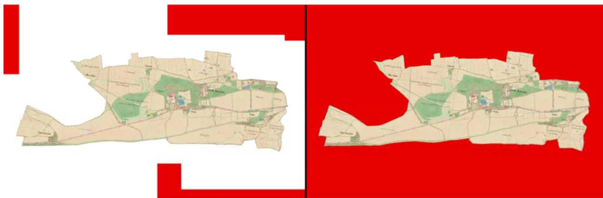
Obr. 7.7: Rozdíl výstupu při zadání parametru NoData 255 a při nezadání. Hodnota NoData je obarvena červeně.
