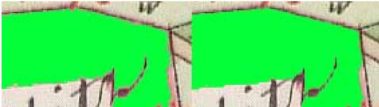
Obr. 5.3: Rozdílný výběr v závislosti na parametru Vyhlazení. Vlevo bez vyhlazení, vpravo s vyhlazením
