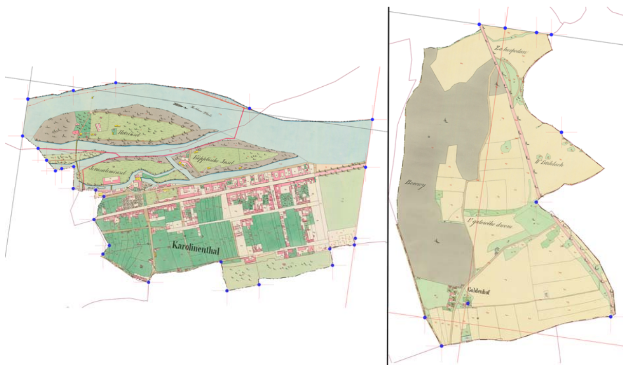
Obr. 7.2: Rozložení vlícovacích bodů. Rovnoměrněji (vlevo) a nerovnoměrněji (vpravo) rozložené vlícovací body (modře).
