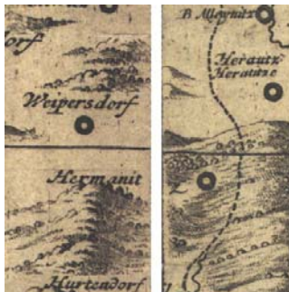
Obr. 19 - Detailní ukázka hranice listů 1 a 2 po projektivní transformaci
